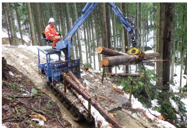
木材用運搬車による搬出
