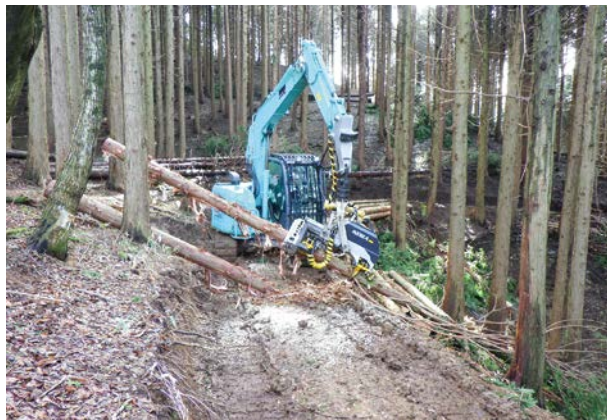
高性能林業機械を用いた造材
